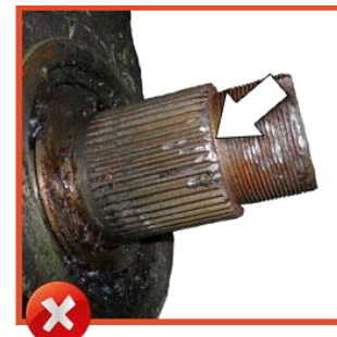
Oštećenje: Neoštečeno (levo) i oštećeni zupšanci (desno).
