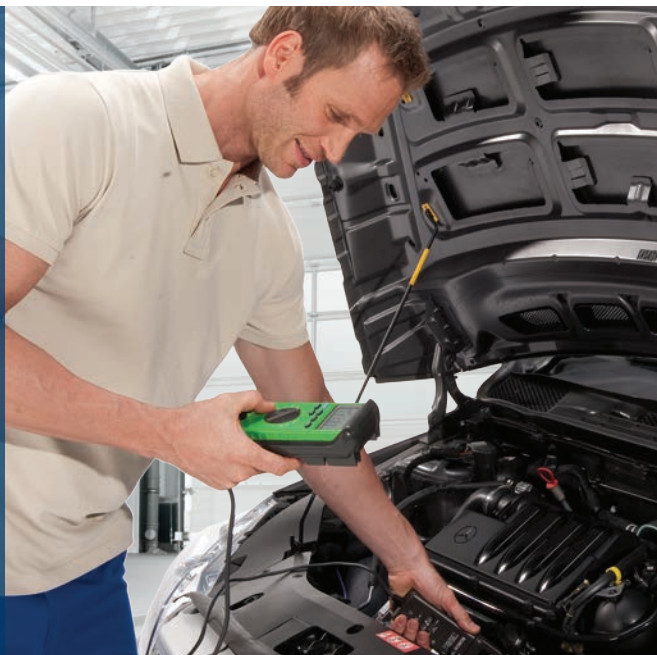
Ispitivanje napona (MMD 302): grejač je potrebno zameniti
