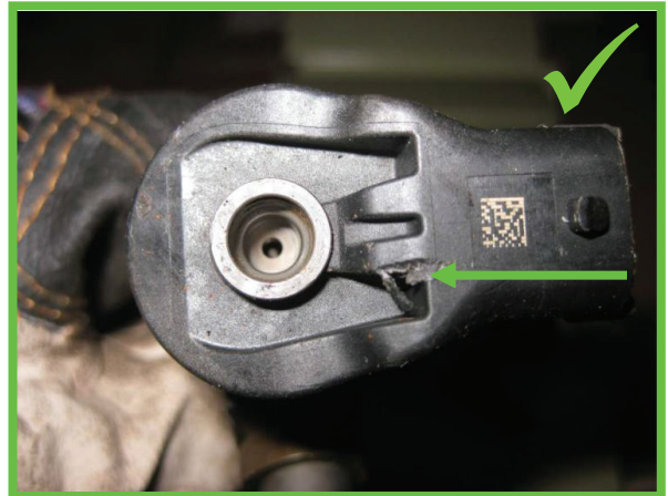
Polomljen nos ventila elektromagneta → prihvatljivo
