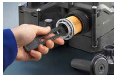
Zamena filtera u Denoxtronic 2.2 sistemu
