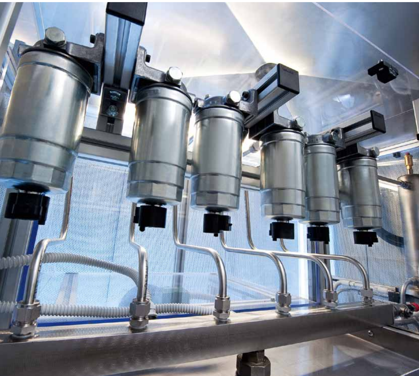
Ispitni sto za merenje pulsiranja pritiska
