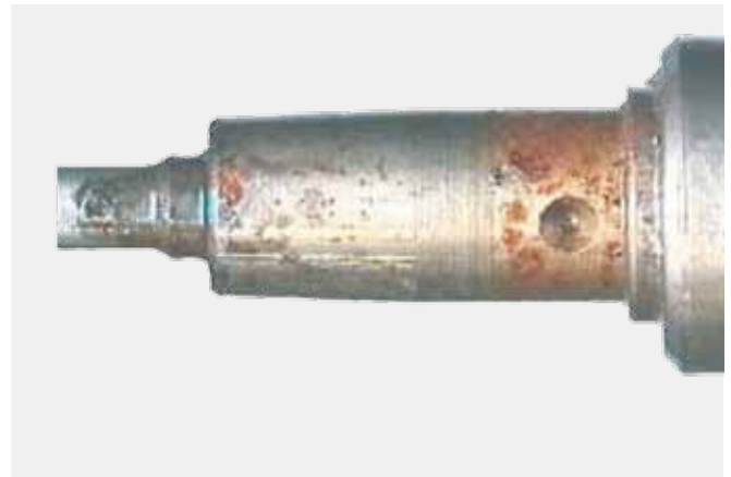
Korozija na injektoru
