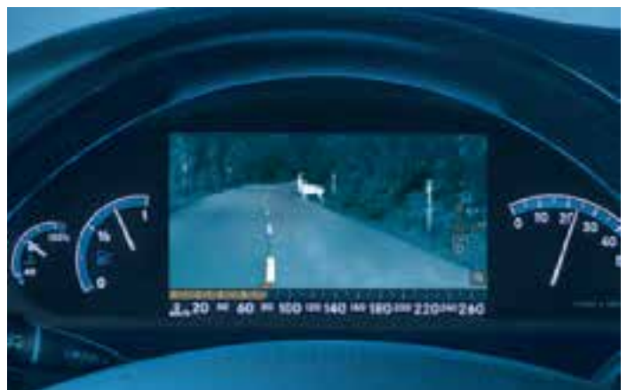
"Night Vision": Pokazuje vozaču put, učesnike u saobraćaju i prepreke na udaljenosti do 150 metara.
