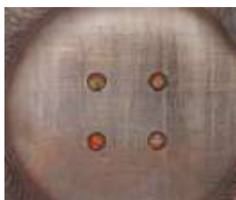
Zaprljana mlaznica injektora pre čišćenja
