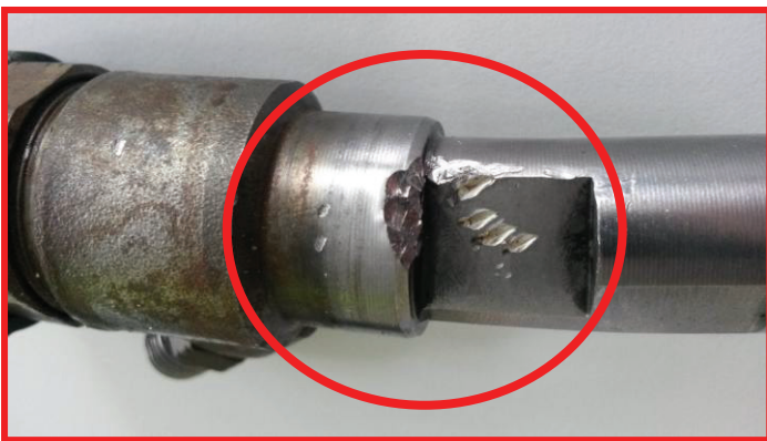
Oštećenje na telu injektora uzrokovano neprikladnim rukovanjem (npr. čekićem) → nije prihvatljivo
